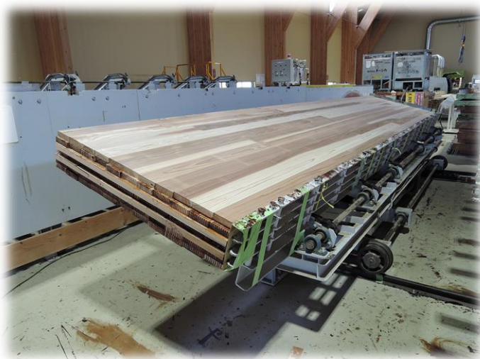
CLT製造ライン
