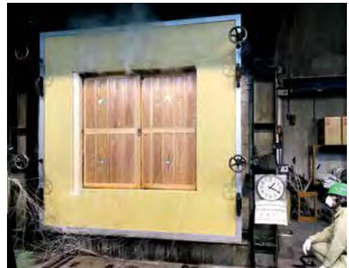
厚さ30mmのスギの雨戸は火災を20分以上遮る
