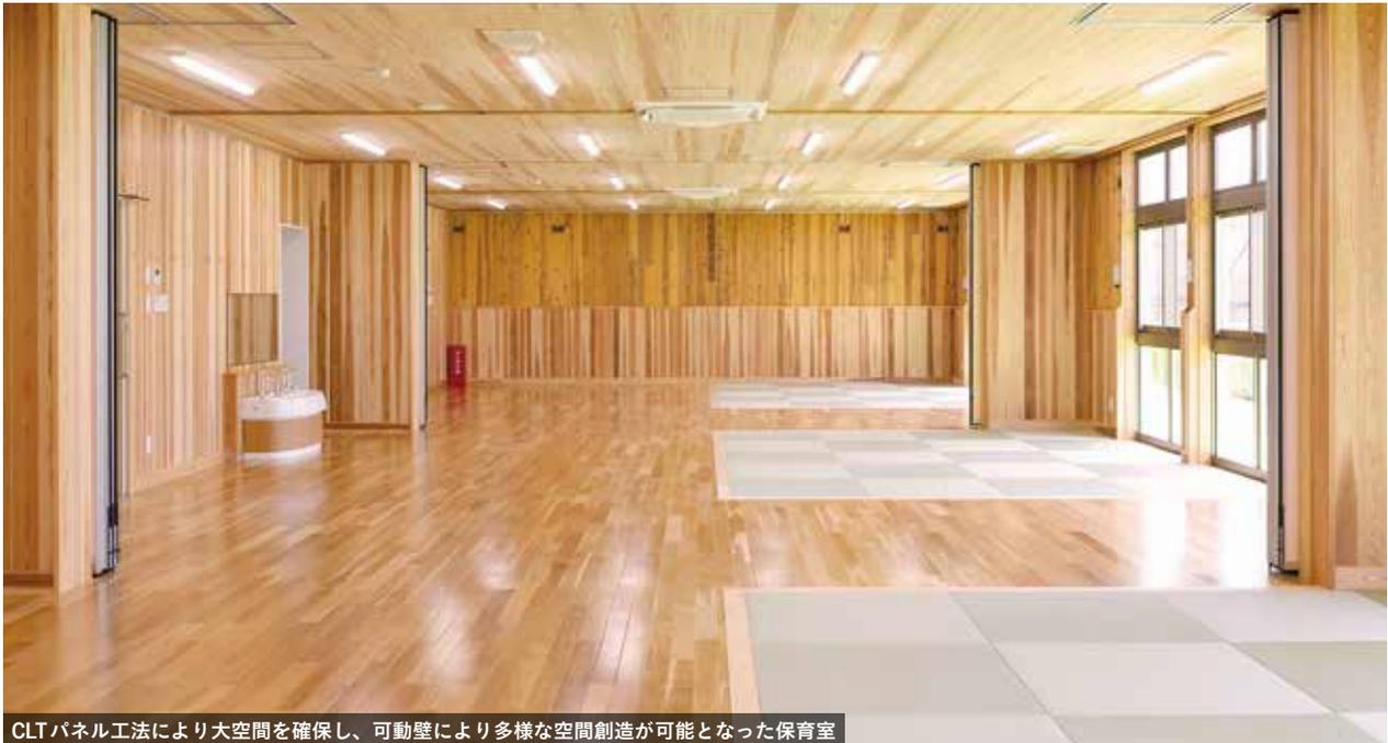
CLTパネル工法により大空間を確保し、可動壁により多様な空間創造が可能となった保育室
